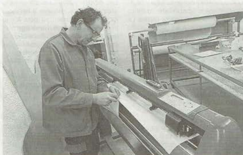
L'ordinateur est relié à une machine de coupe, dont la lame cutter coupe le vinyle pour obtenir un pochoir. Le pochoir de vinyle obtenu est posé sur la feuille de verre et définit la zone à sabler.
